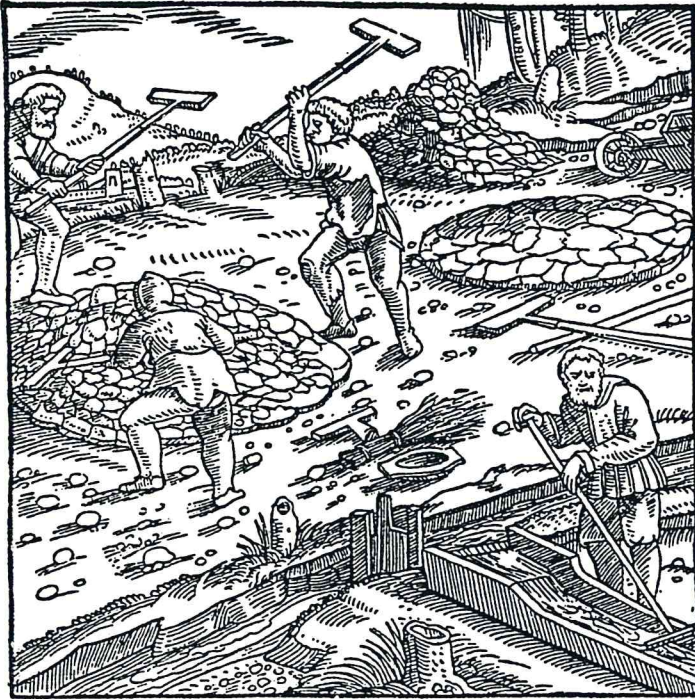
Erzwäsche. Nach der Zerkleinerung des Erzes wurden die erdigen Bestandteile in einem Sieb oder in einer Wasserrinne ausgewaschen.
