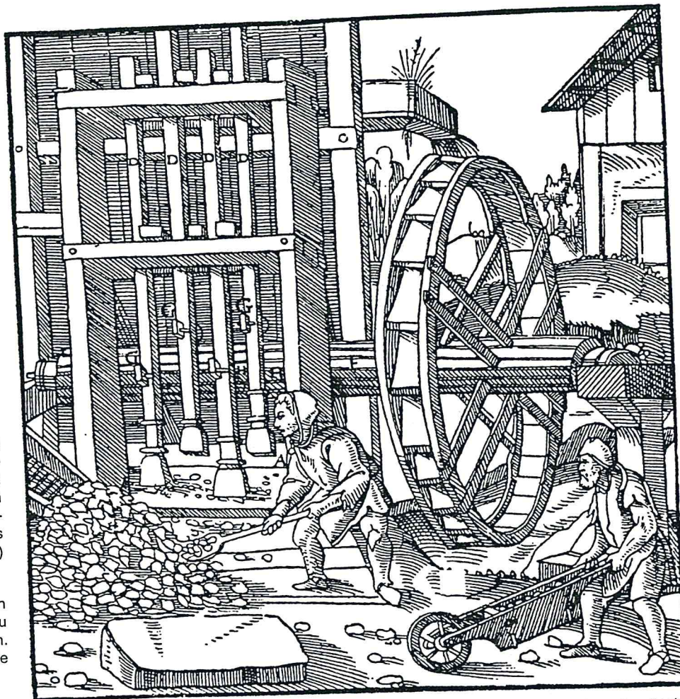
Erzpochwerk. Zum Zerkleinern der Erze benutzte man meistens Pochwerke oder Pochhämmer, die von Wasserrädern angetrieben wurden.
